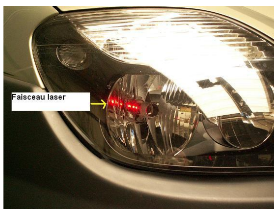
Exemple de centrage avec dispositif à visée laser
